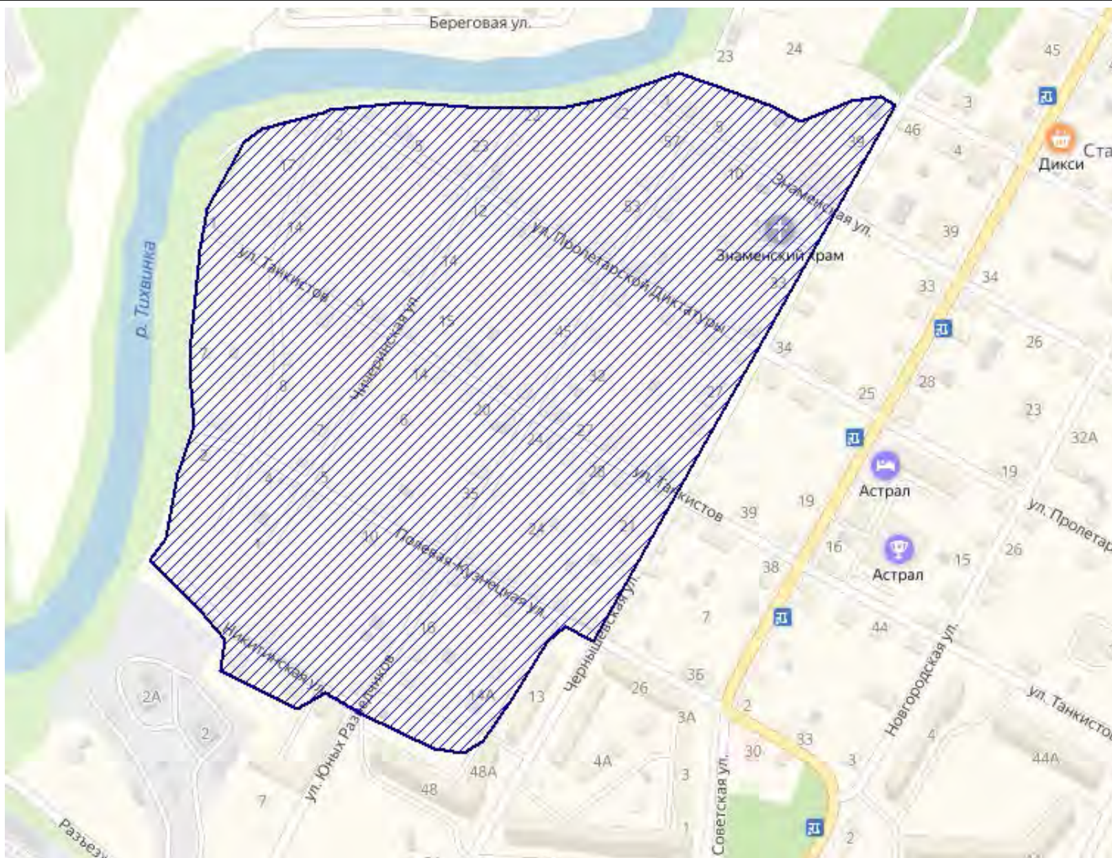
Рисунок 18. Планируемая зона охвата системой централизованного водоснабжения существующей индивидуальной жилой и общественной застройки в районе ул. Юных Разведчиков и ул. Береговая-Кузнецкая.
