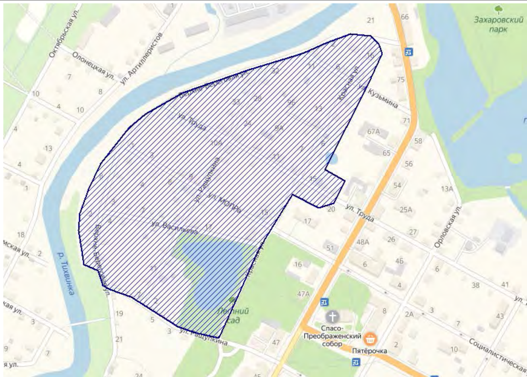
Рисунок 16. Планируемая зона охвата системой централизованного водоснабжения существующей индивидуальной жилой и общественной застройки в районе ул. Верхне-Береговая, ул. Труда и ул. Ращупкина.
